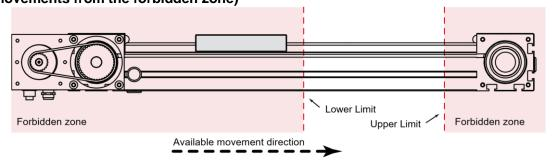
Per utilizzare la gestione delle quote limite è necessario, prima di abilitarne la gestione, definire il valore della quota limite inferiore e quello della quota limite superiore.
